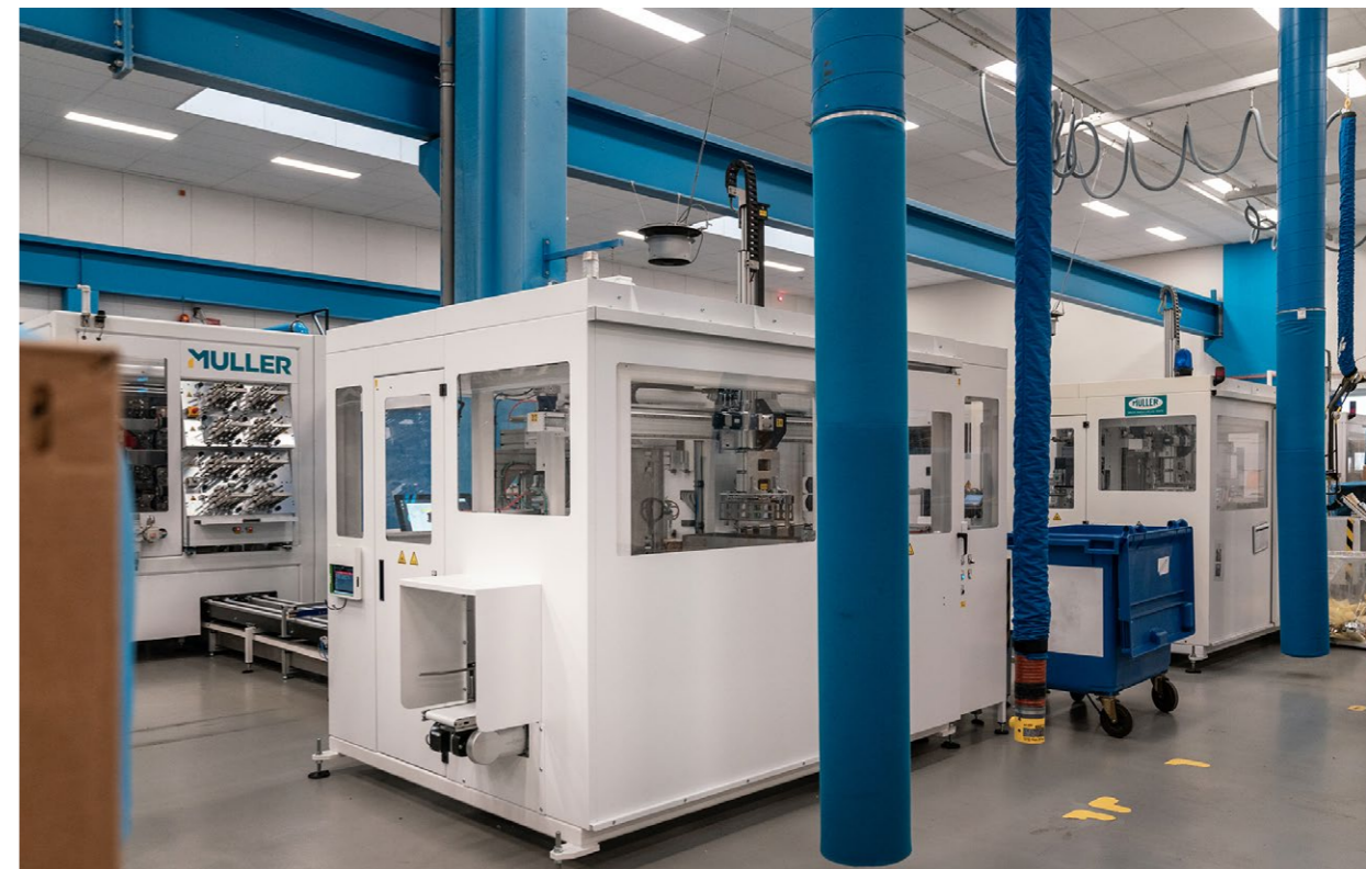
▲ De nye, fuldelektriske maskiner bruger kun cirka en tredjedel af den energi, som de ældre hydrauliske maskiner bruger på at producere mejeri-emballage.
