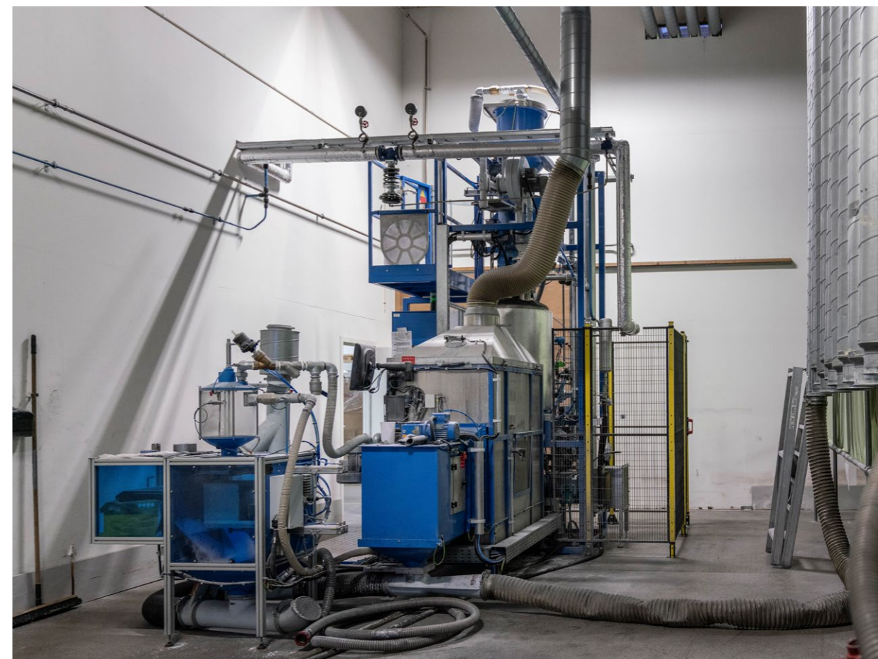
▲ En ny forskummer til produktion af EPS har ud over at give både tilskud og en markant besparelse også medført en bedre kvalitet af de producerede emner.
