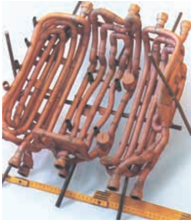
Kølerør til indstøbning i form (BASF)
