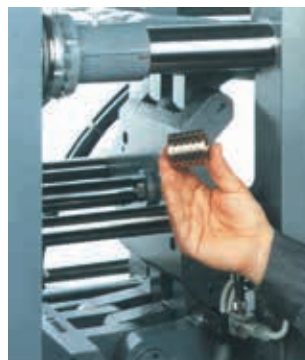
Knæledslukkeenheden er med selvsmørende lejer (Battenfeld)
