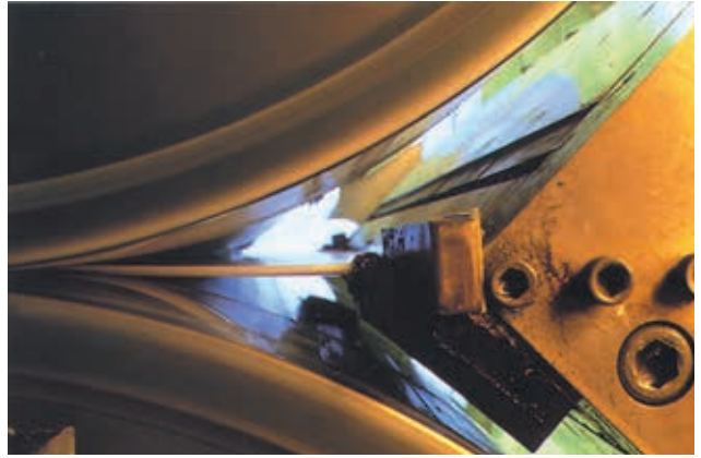
Folien forlader dysen mellem to glattevalser (CLOEREN)
