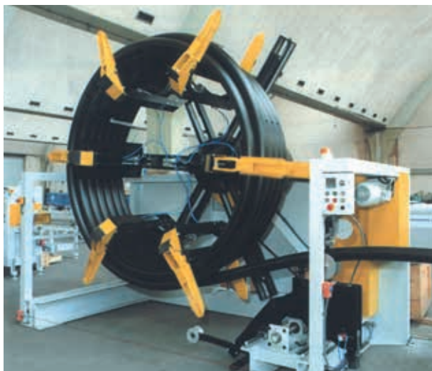
Spoleapparat til rør (Battenfeld)
