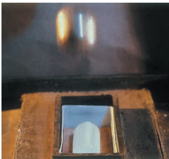
Slagprøvning af flasker med 2 kg-kugle (BASF)
