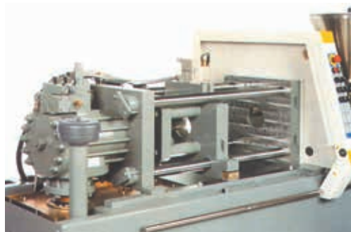
To-trins fuldhydraulisk lukkeenhed (Battenfeld)
