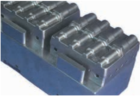
Positivform til fremstilling af tændrørs-emballe (ILLIG)
