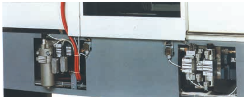
Den hydrauliske lukkesikring (Battenfeld)
