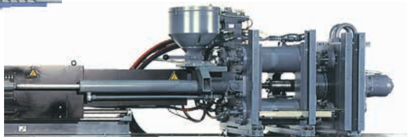
Fuldhydraulisk sprøjtestøbeenhed med fire dobbeltvirkende, hydrauliske sprøjtecylindre (Battenfeld)
