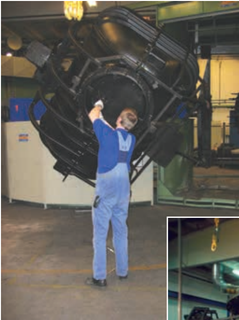
Rotationsstøbning af trekammertank (Wavin)
