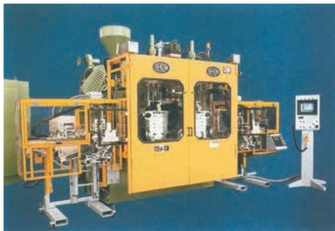
Blæsestøbmaskine til fremstilling af flasker, små dunke og andre mindre emner (Bekum)
