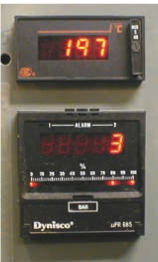
Øverst aflæsning af opnået massetemperatur. Nederst aflæsning af masse-tryk (ekstruderen kører ikke)
