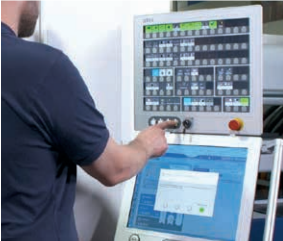
Betjening af en Netstal sprøjttestøbemaskine med touch screen-styring (KraussMaffei)
