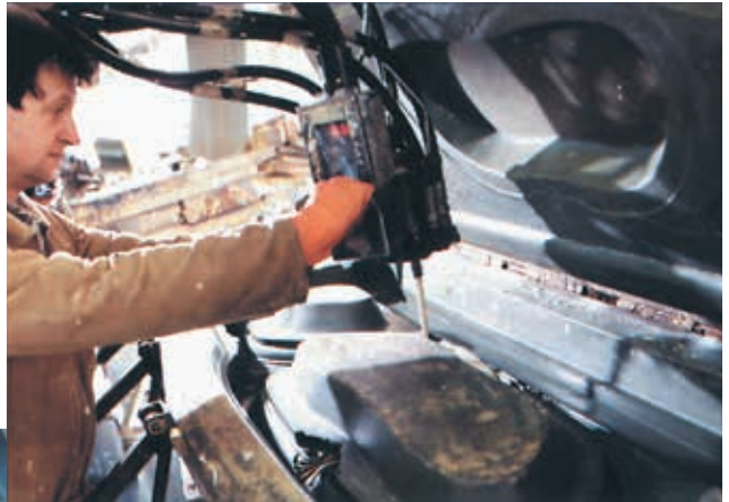
Formfyldning, åben form (Nortech-Cannon A/S)
