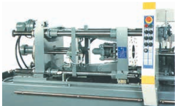
Knæledslukkeenhed med integreret mellemlade (Battenfeld)
