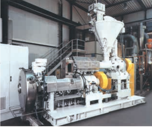
Planetvalseekstruder med pelleteringsudstyr (Battenfeld)
